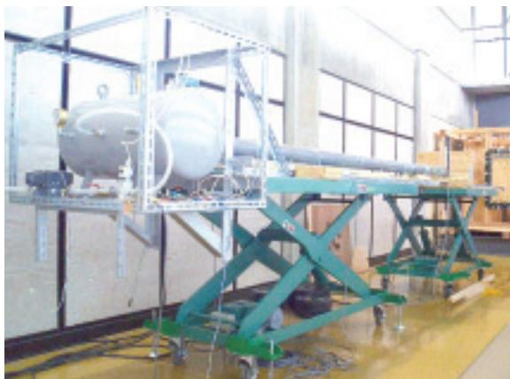
写真-20 エアーキャノン式射出装置<sup>20)</sup>
